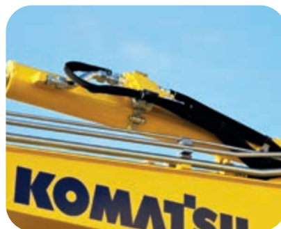
Valvole di sicurezza cilindri braccio e avambraccio
