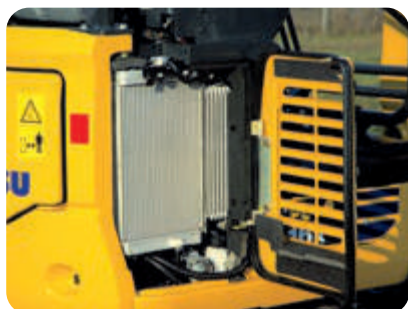
Cofano destro: ispezione e pulizia dei radiatori
