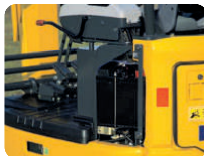
Cofano sinistro: accesso alla batteria
