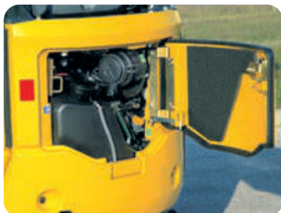
Cofano posteriore: controllo del motore e rifornimento carburante
